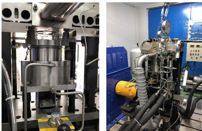
国内领先的双燃料喷射光学发动机实验平台
