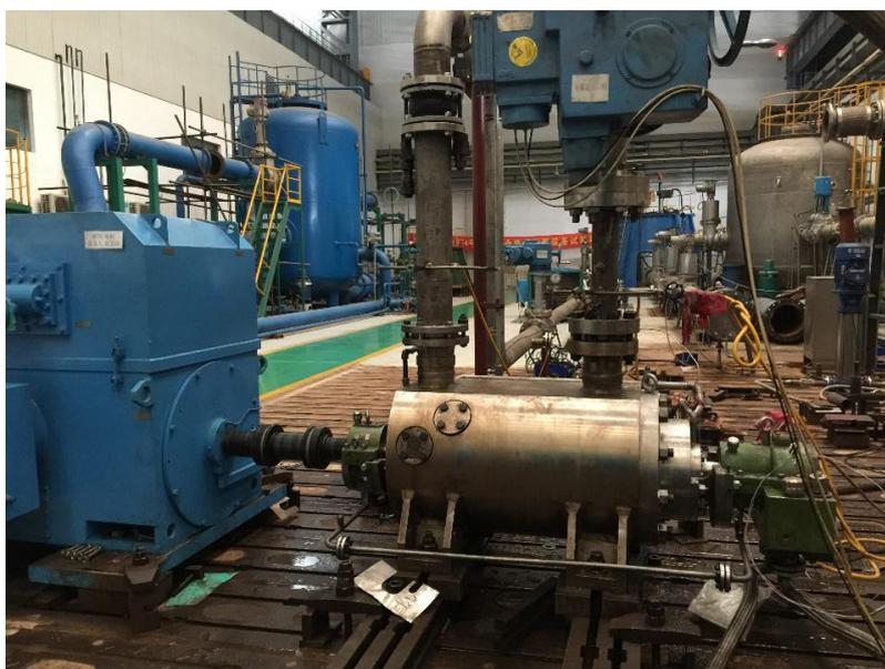
图 1 先进百万千瓦级压水堆“华龙一号”电动辅助给水泵
