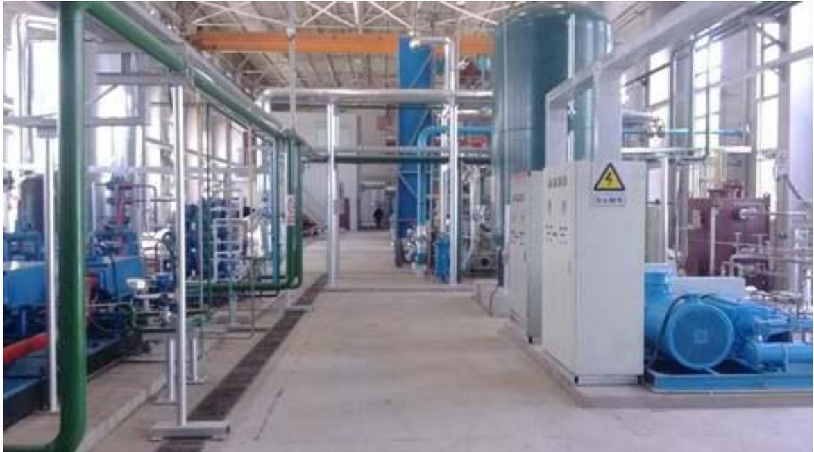
图 1 中科院工程热物理所先进超临界压缩空气储能系统
